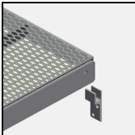
2. Skru fast brakket til vegg. Bruk M08x50 treskru. Ved betong bør det legges inn nylonpluggar. Legg gummiinnlegg i braketten. Plasser repos ned i brakett.
