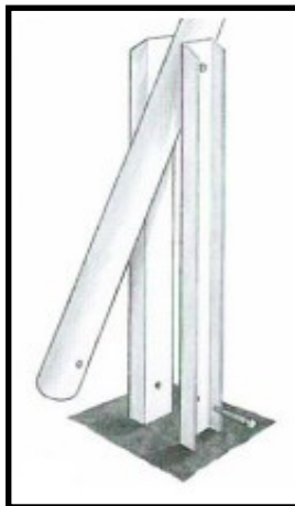
14. Ta ut bolt, og sett flaggstang på plass.
