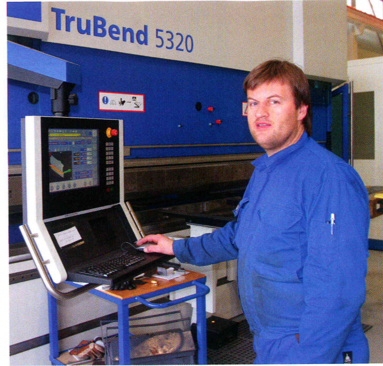
Med en nye kantpressen kan klarer maskinoperatør Tor Olav Lorentsen platebredder helt opp til 4,4 meter.
